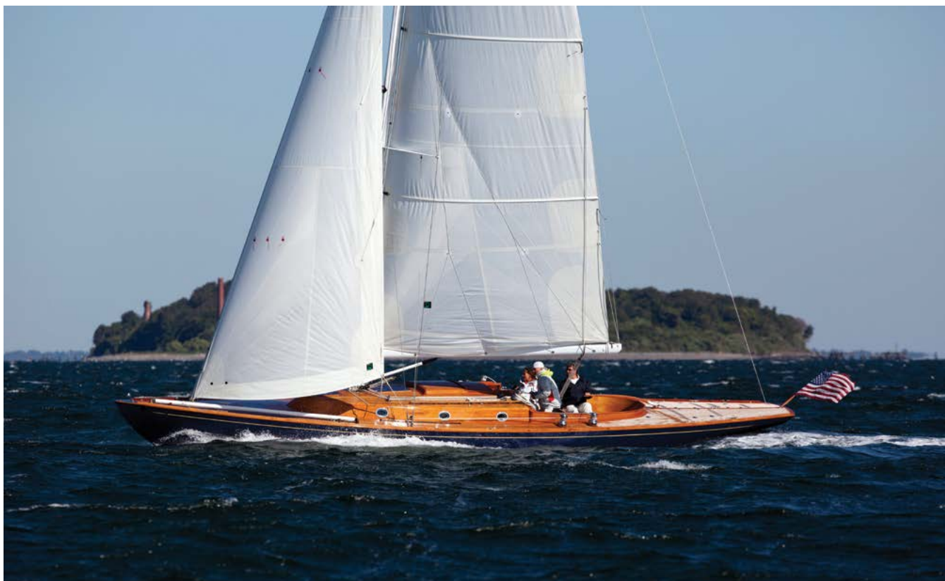
Spirit. נשוייה מעץ טבעי, נראית כמו מפרשית קלאסית אך מונעת ב-100 אחוז חשמל. פאנלים סולאריים והידרו-גנרטור טוענים מצבר, ומנוע חשמלי קטן מספק דחף כשצריך
