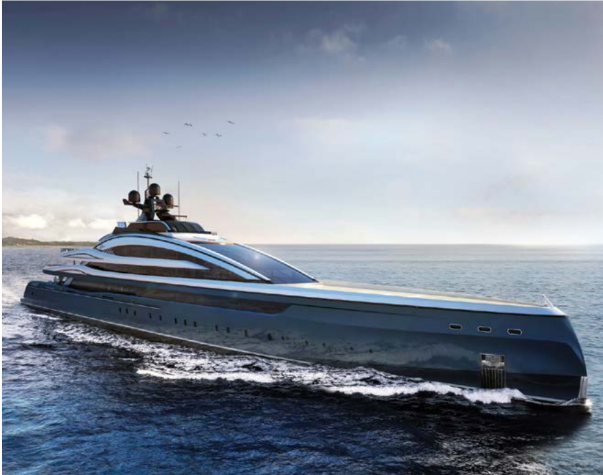
Hydrotec - ארמון שט באורך 40 מטר. שני מנועי סימנס חשמליים, מהירות עד שמונה קשר
