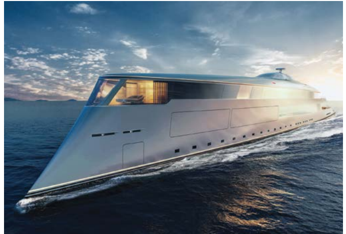
Aqua , מרהיבה לאורך 112 מטר. תאי דלק המנצלים מימן להפקת חשמל מניעים אותה. למהירות עד 17 קשר ולטווח 4,000 ק"מ
